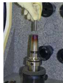
Die abgebrochene Schneide kann be- quem herausgezogen werden
