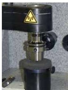
Schrumpffutter erwärmen. Sobald das Schrumpf- futter die Ausschumpftemperatur erreicht hat, fällt es auf die Dämpfungsscheibe
