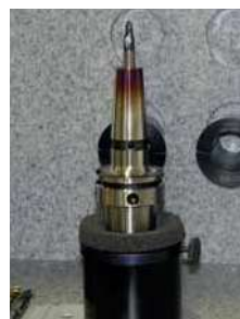
Schrumpffutter erwärmen. Sobald das Schrumpf- futter die Ausschumpftemperatur erreicht hat, fällt es auf die Dämpfungsscheibe
