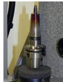
Schrumpffutter auf den Pin setzen
