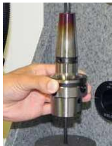
Länge bis zum An- schlag der Werkzeug- schneide bestimmen
