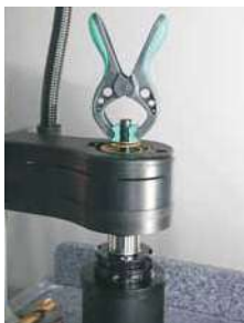
Druckfeder ist gespannt, das Schneidwerkzeug wird von der Zange gehalten. Schrumpffutter erwärmen
