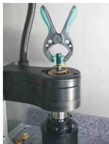
Druckfeder ist entspannt, sobald das Schrumpffutter die richtige „Loslass-Temperatur“ hat
