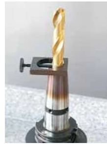
Schrumpffutter abkühlen lassen
