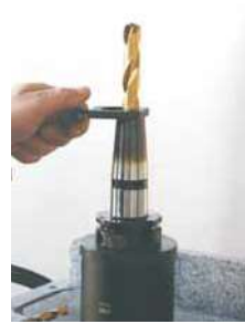
Schneidwerkzeug bis zum Anschlag einsetzen
