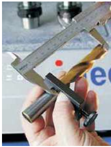
Festlegen der Auskraglänge des Schneidwerkzeugs
