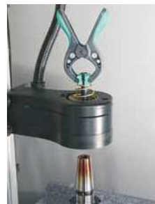
Zange wird mit dem Schneidwerkzeug nach oben gedrückt. Der Induktor kann hochgefahren werden
