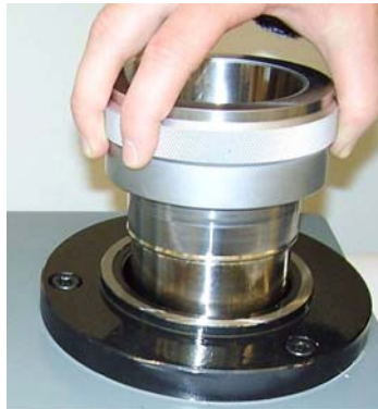
Figure 7 : Insertion de la bague de fixation (accessoire) dans le support de l'adaptateur.
