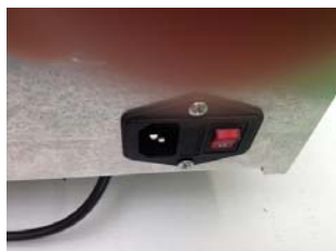
Figura 3: Interruptor principal, incluindo fusível, na parte traseira do aparelho
