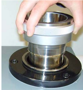
Figura 7: Inserimento della boccia di guida (accessorio) nella sede dell'adattatore.
