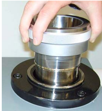
Рис. 7: Вставка зажимной втулки (принадлежность) в основной зажим с адаптером
