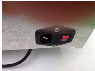
Abbildung 3: Hauptschalter inklusive Sicherung an der Rückseite des Gerätes
