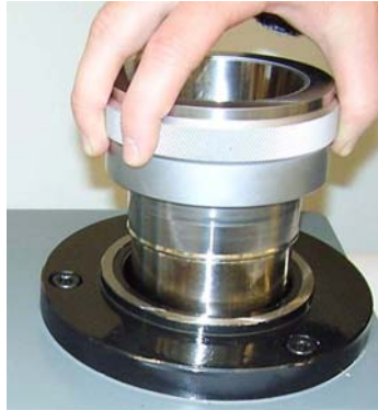
Abbildung 7: Einsetzen der Aufnahmhülse (Zubehör) in die Adaptionaufnahme
