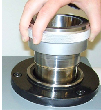
Figura 7: Colocação do porta-mandris (acessório) no alojamento do adaptador
