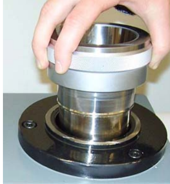
Resim 7: Yerleşim kovanının (aksesuar) alet yerleşimine yerleştirilmesi
