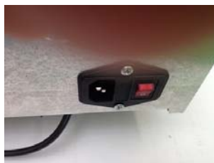
Figura 3: Interruttore principale con fusibile sul retro del dispositivo
